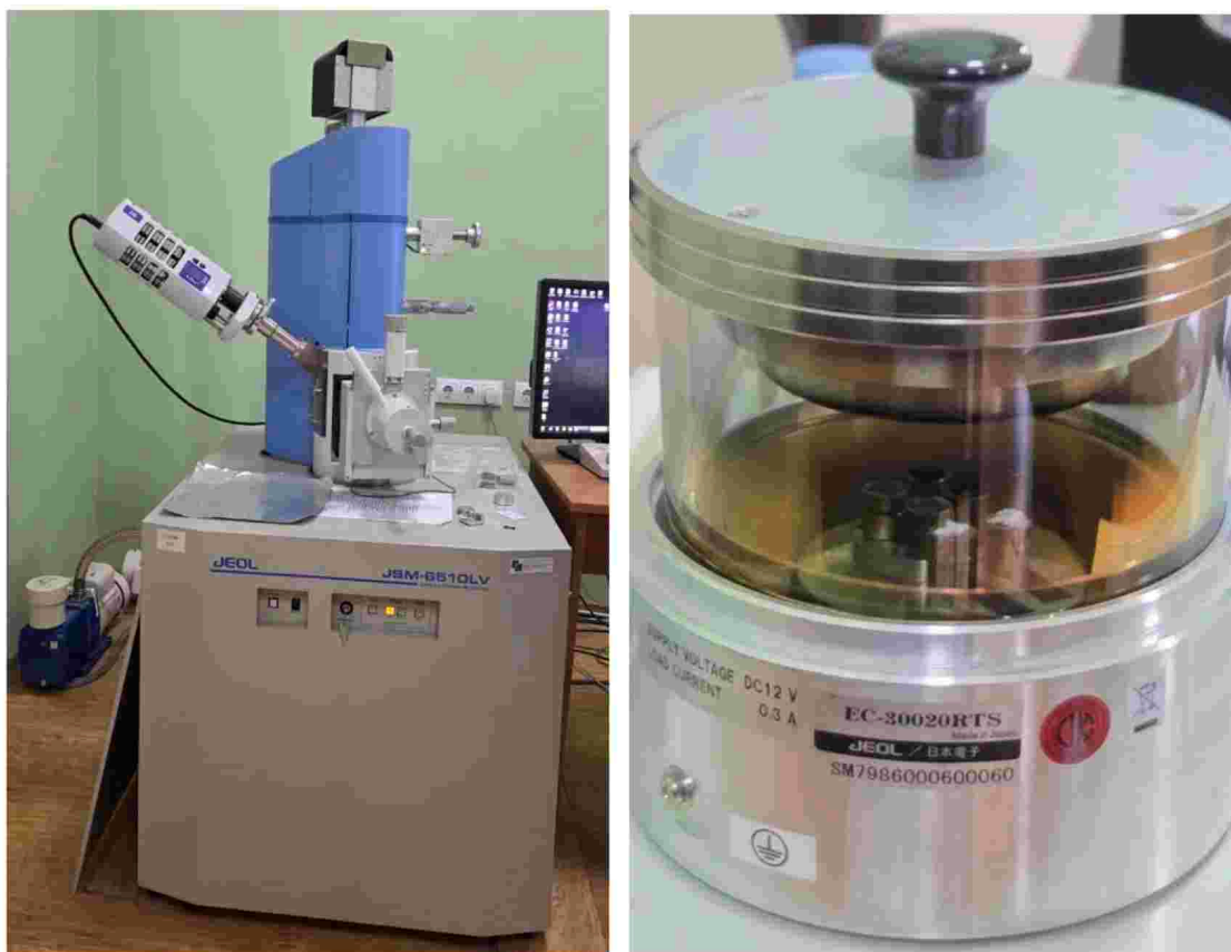
9 сурет - а) СЭМ; ә) алтын бүркігіш құрылғы
