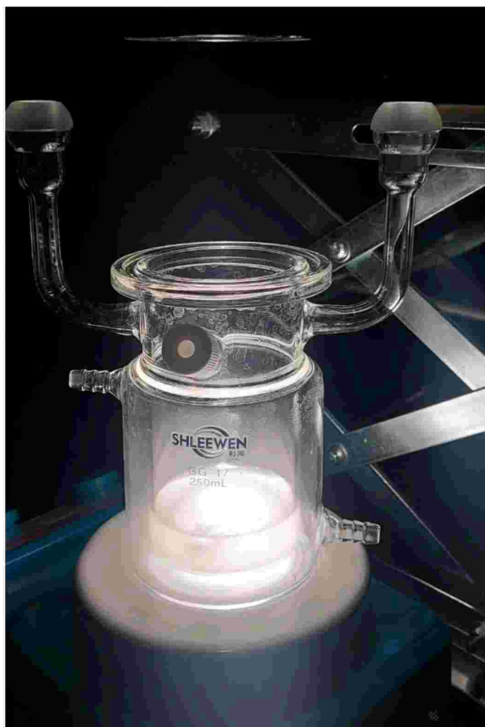
12 сурет - Ксенон жарығы арқылы фотокатализді текесру
