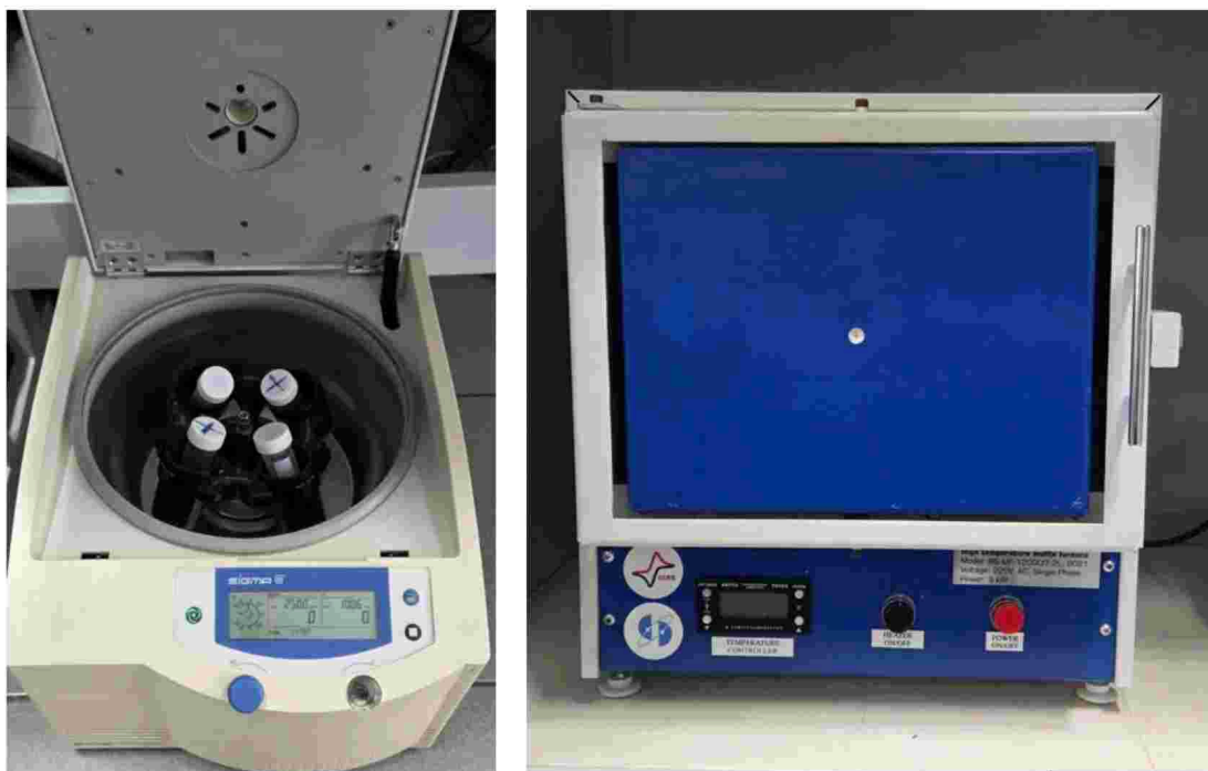
1 сурет - Синтез жасалған негізгі құрылғылар: а) центрифуга; ә) муфельді пеш
