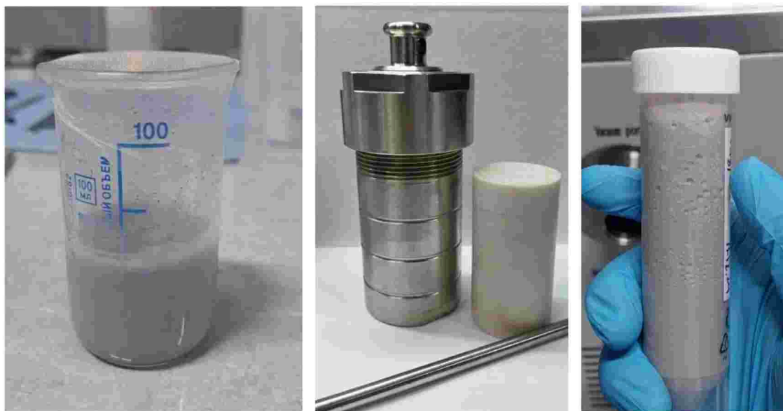
5 сурет - Гидротермиялық әдістің негізгі кезеңдері: а) дисперсиялау; ә) автоклаптағы суспензия; б) центрифугалау
